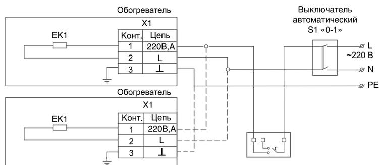
Рис. 3. Пример подключения нескольких обогревателей через терморегулятор
